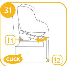
! Wspornik obciążenia musi być zainstalowany prawidłowo, ze wskazaniem zielonego koloru. 31 -2
