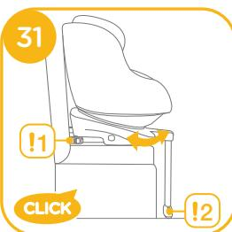
! Das Standbein muss richtig installiert sein, was durch eine grüne Anzeige überprüft werden kann. **31 -2**
