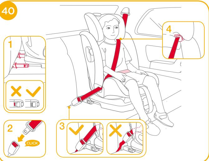
1.請確定左右兩邊的ISO safe 連接器都已固定到ISOFIX固定點上且兩個ISO safe 連接器上的指示器應顯示綠色 40-1
