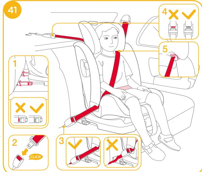
1.請確定左右兩邊的ISO safe 連接器都已固定到ISOFIX固定點上且兩個ISO safe 連接器上的指示器應顯示綠色 41-1
