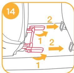
4. 將Isosafe連接器與ISOFIX固定點對齊，然後將兩個Isosafe連接器與ISOFIX固定點卡合連接<sup>15</sup>
